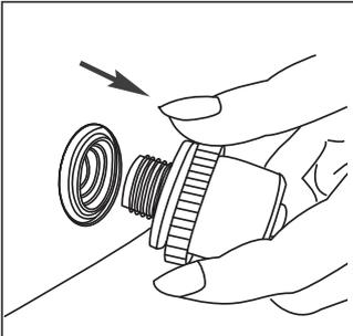
El diagrama muestra una mano desinflando la válvula de la bañera del spa. Se indica que se debe desenroscar completamente la válvula para desinflarla.
