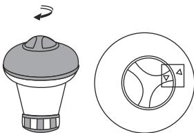
Tournez le couvercle supérieur dans le sens inverse des aiguilles d'une montre jusqu'à ce que les deux flèches se rencontrent.
