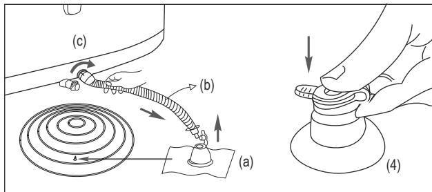
1. Abre la válvula de aire (c) de la bañera del spa. Asegúrese de seleccionar la negra. Abra la válvula de aire (a) de la cámara. Inserte la manguera de inflado (b) en la v álvula.
